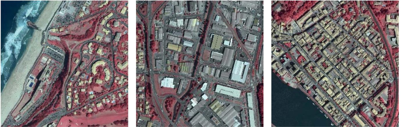
L'ajout du spectre infrarouge à l'orthophoto 2009 est indispensable, il permet d'identifier aisément les zones avec une présence de végétation. Contrairement à la zone d'activités et au quartier Saint-Esprit, le front de mer semble à priori présenter une perméabilité plus importante que les autres tissus.
