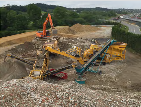
Plateforme de valorisation des déchets du BTP sur le département 64 - Source entreprise Goyetche à Bidart.
