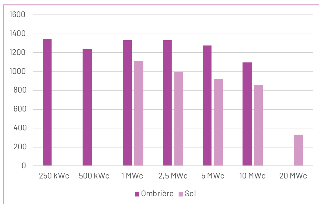
Variation des CAPEX (€/KWc) en fonction de la taille de l'installation - Source : CRE, traitement a'urba
